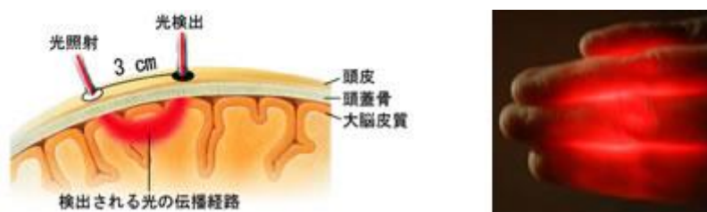
図 1. NIRS の測定原理 (出典：株式会社日立メディコ「光トポグラフィ技術の活用」 http://www.hitachi.co.jp/products/ot/hardware/principle.html )
